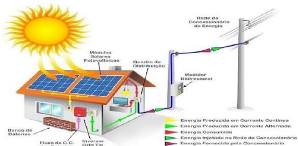
FIGURA 04 – Sistema de produção de energia em residência.
