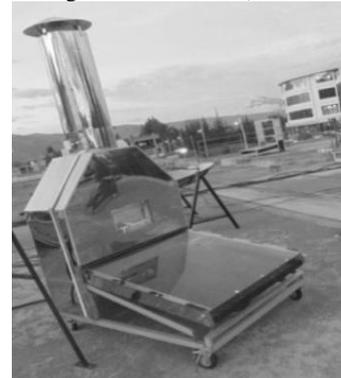
Fig.2. Prototipo de secador solar.
