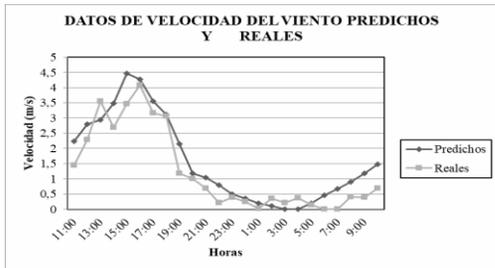
Fig.6. Gráfico de comparación entre datos reales y predichos usando la teoría del caos de velocidad del viento.
