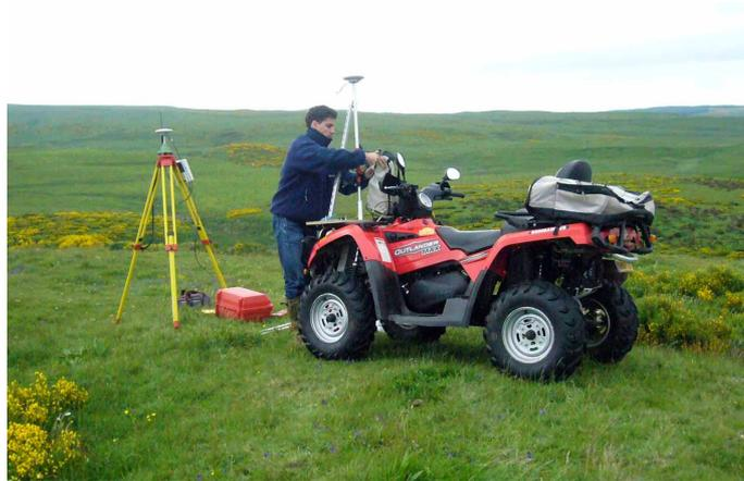
Fig. 7 : installation du GPS centimétrique Leica sur un quad.
