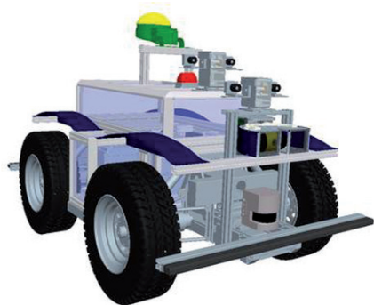
Abb. 4: RAVON, ausgestattet mit multiplen Sensoren zur Umwelterfassung (Quelle: uni-kl.delravon).
