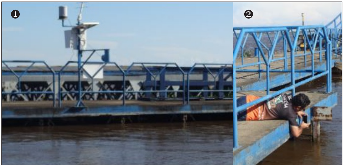
Figura 10. Estação de medição automática no Porto de Óbidos (1). Régua linométrica de medição do nível do rio, a leitura desta régua é realizada duas vezes por dia por morador local (2). Fonte: Valdenira Santos.
