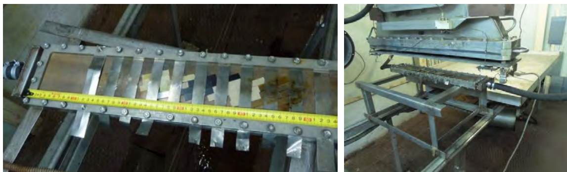
Рис. 1. Образцы на водоохлаждаемом коллекторе и коллектор с образцами под выпускным окном ускорителя ИЛУ-6
