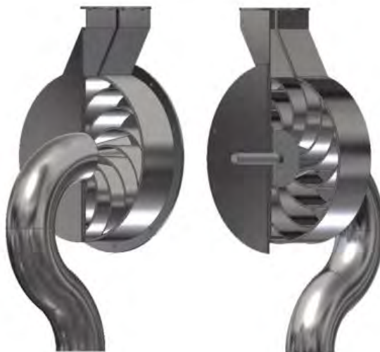
Рис. 2. 3D модель конструкции новой гидротурбины
