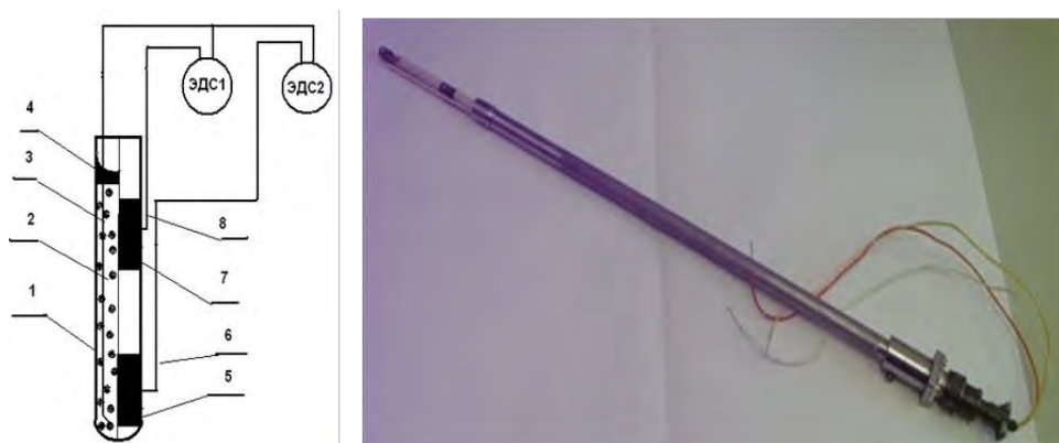
Рис. 1. Схема и общий вид сенсора: 1 – твердоэлектролитная пробирка YSZ; 2 – эталонный электрод Ni-NiO; 3 - потенциосъемник с эталонного электрода; 4 – герметик; 5 – измерительный электрод для расплава; 6 – потенциосъемник с измерительного электрода для расплава, 8 – потенциосъемники с измерительного электрода для атмосферы; 7 – измерительный электрод для атмосферы; 8 – потенциосъемник с измерительного электрода для атмосферы; ЭДС1 и ЭДС2 – потенциометры
