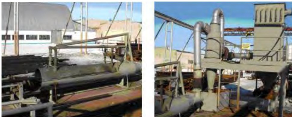
Рис. 2. Модульная передвижная установка по очистке внутренней поверхности труб
