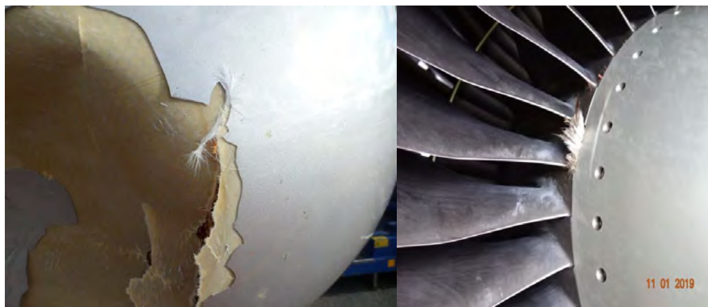
Рис. 1. Перья птиц на обшивке локатора и лопатках турбины двигателя
