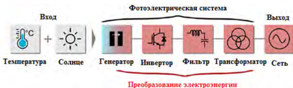
Рис. 1. Общая структура подключенной к сети системы преобразования фотоэлектрической энергии, в которой блок «генератор» представляет собой фотоэлектрические панели, которые генерируют энергию на основе фотоэлектрического эффекта.
