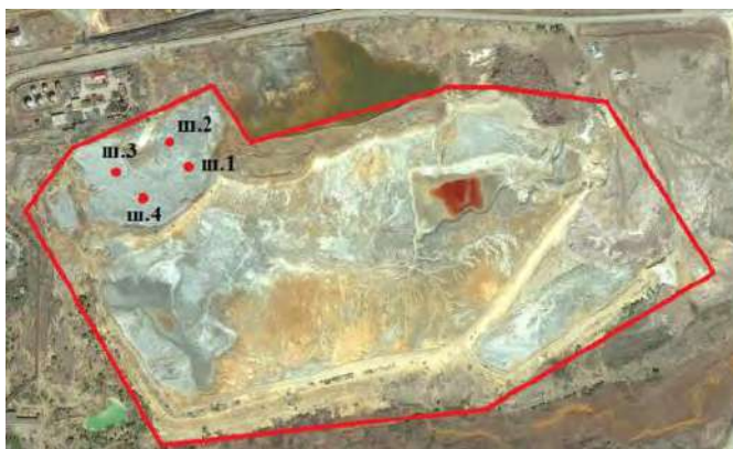
Рис. 1. План расположения разведочных выработок Сибайского хвостохранилища
