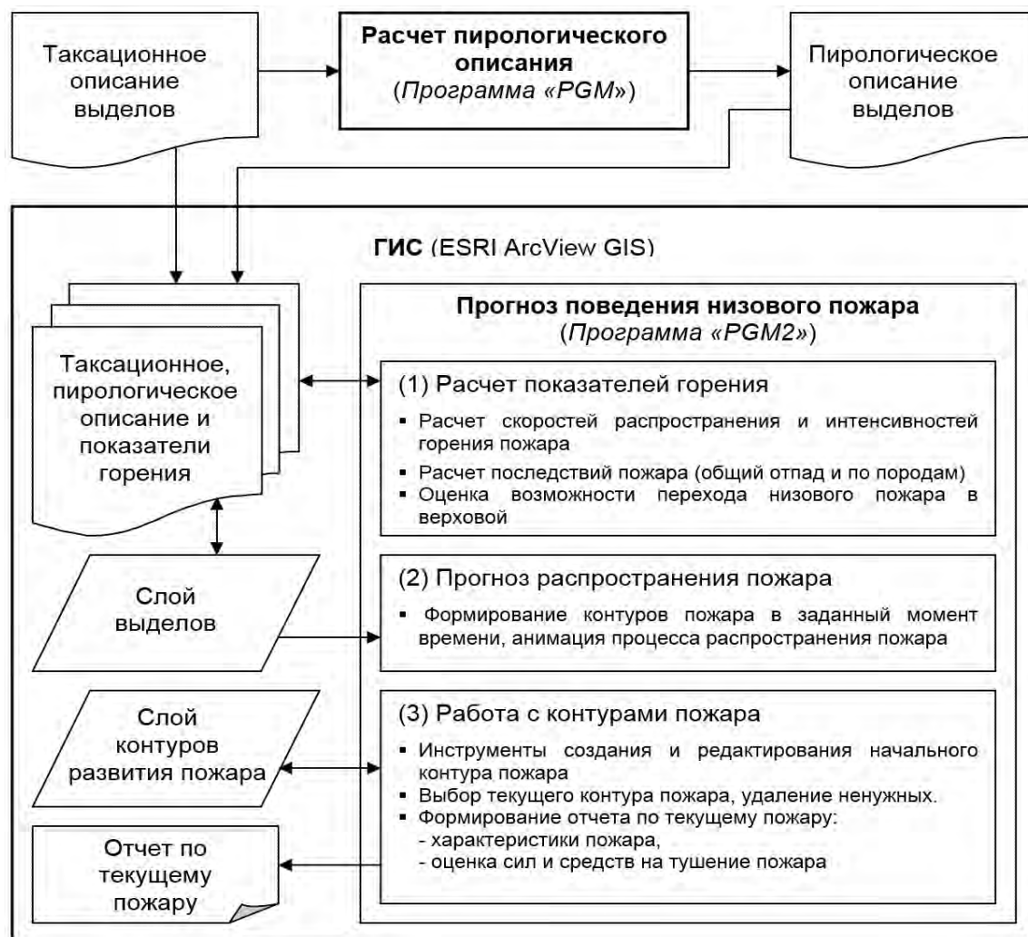
Рис. 1. Структурная схема функционирования программного обеспечения (PGM и PGM2) для расчета пирологического описания выделов и прогноза поведения низового пожара
