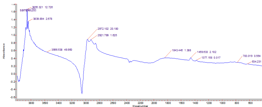
Рис. 4. ИК-спектр облученных образцов смолистой фракции нефти с поверхности воды (D = 110 кГр)
