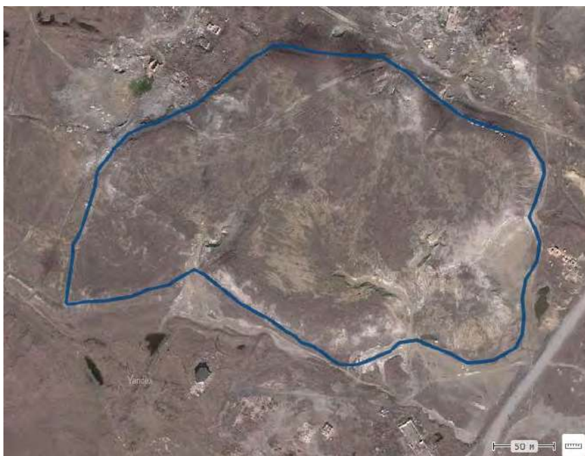
Рис.2. Оконтуренная площадь Новотроицкого хвостохранилища на космоснимке с развитой по его склонам эрозионной формой рельефа.
