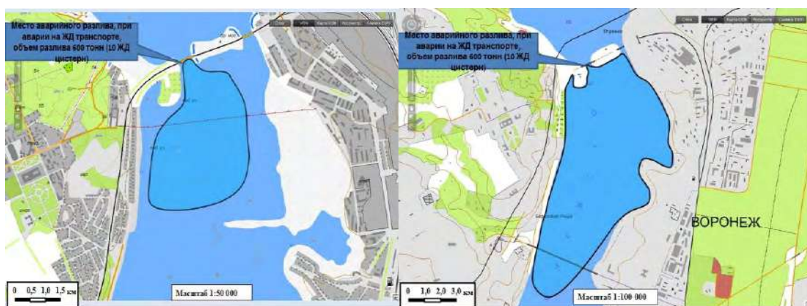
Рис. 4. Модель распространения нефти по площади акватории Воронежского водохранилища на основе расчетных створов при аварии на железнодорожном транспорте
