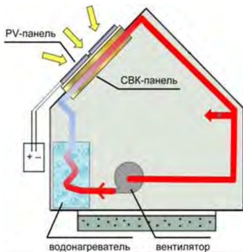
Рис.1. Комбинированный солнечный воздушный коллектор с отбором тепла от фотоэлектрических модулей для теплоснабжения зданий
