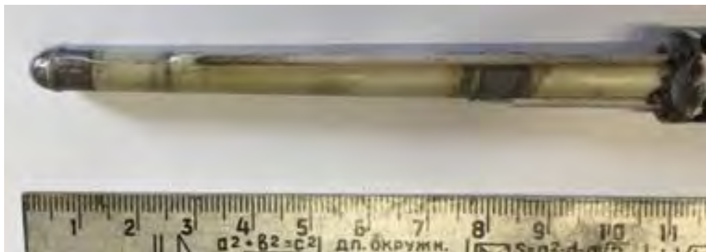
Рис. 6. Внешний вид сенсора после длительных измерений в расплаве LiCl-Li 2 O
