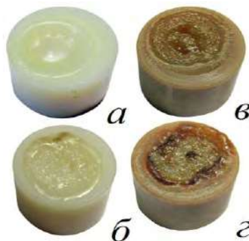
Рис. 1. Фотографии поверхности, сформированной после облучения лазером в течение 10 с ( а, в ) и 30 с ( б, г ) исходного ( а, б ) и предварительно \gamma -облученных ( в, г ) образцов ПА. Доза \gamma - облучения 3500 кГр при 300 К.
