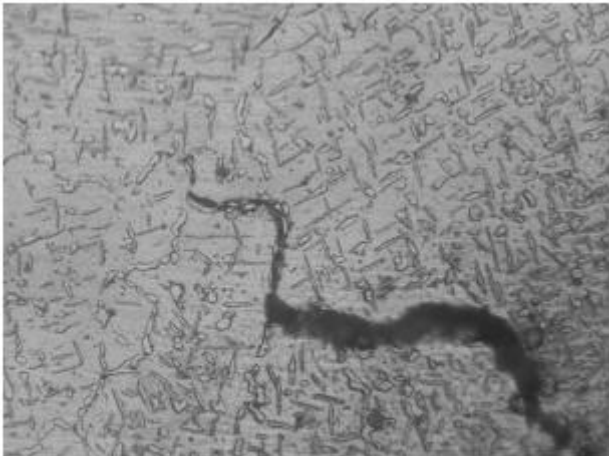
Фиг.7 Образуване на корозионна пукнатина на разстояние от повърхността в обкръжение на структура без видимо корозионно повреждане (400:1).
