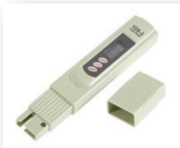
Gambar 3.3 Pupuk AB-mix (atas) dan TDS meter (bawah)
