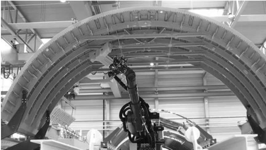
Abbildung 8: Prüfaufbau an einer Flugzeugrumpfschale (Foto: Fraunhofer IFF)
