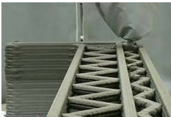
Фиг.3 Снимка на послойно екструдирание на строителни смеси [Savytskyi et al. 2016]
