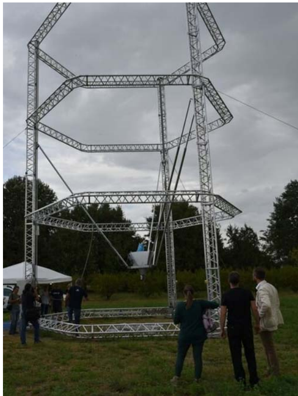
Фиг.7 Конструкция на делта 3D принтер за строителни смеси [Borghino 2015]
