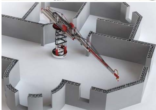
Фиг.6 Конструкция на 3D принтер за строителни смеси работещ в цилиндрична координатна система [Alter 2015]
