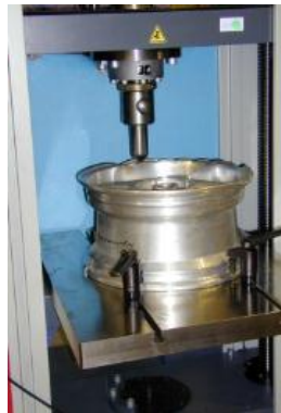
Eindrckversuch an Felgen
