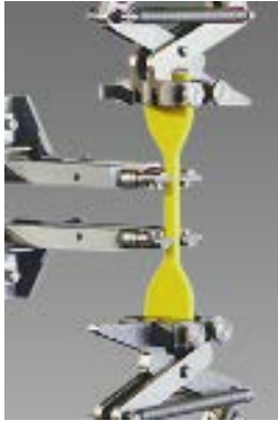
Zugversuch an Normprobe
