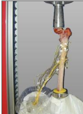
Druckversuch an Knochen
