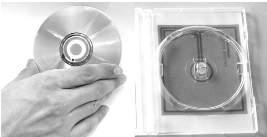
Abb. 3. CD/DVD-Transponder und „BoosterLabel“ (Quelle: Nedap)
