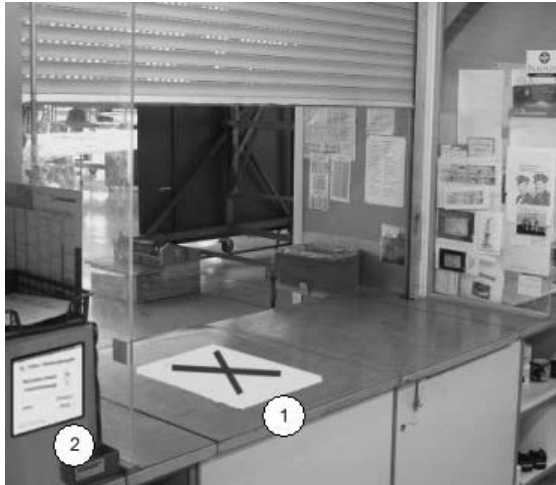
Abb. 6. Smarte Werkzeugausgabe mit RFID-Antenne (Nr. 1) und Bildschirm (Nr. 2)
