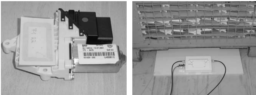
Abb. 3. Fensterhebermotor mit RFID-Tag und Metallcontainer mit Leseantenne
