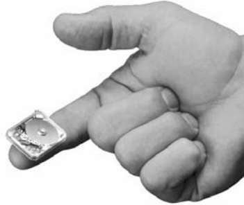
Abb. 4. Eine 4-GB/0,85-Zoll Harddisk von Toshiba (2004)
