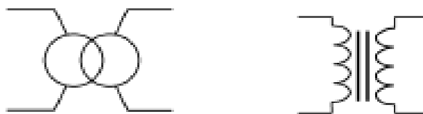
Figure 37: Symbole d'un transformateur monophasé
