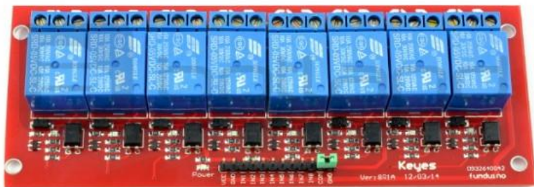
Fot. 5. Panel przekaźników
