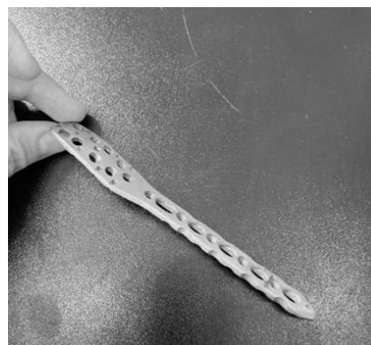
Рисунок 6. Модель пластины для фиксации распечатанный на 3D принтере
