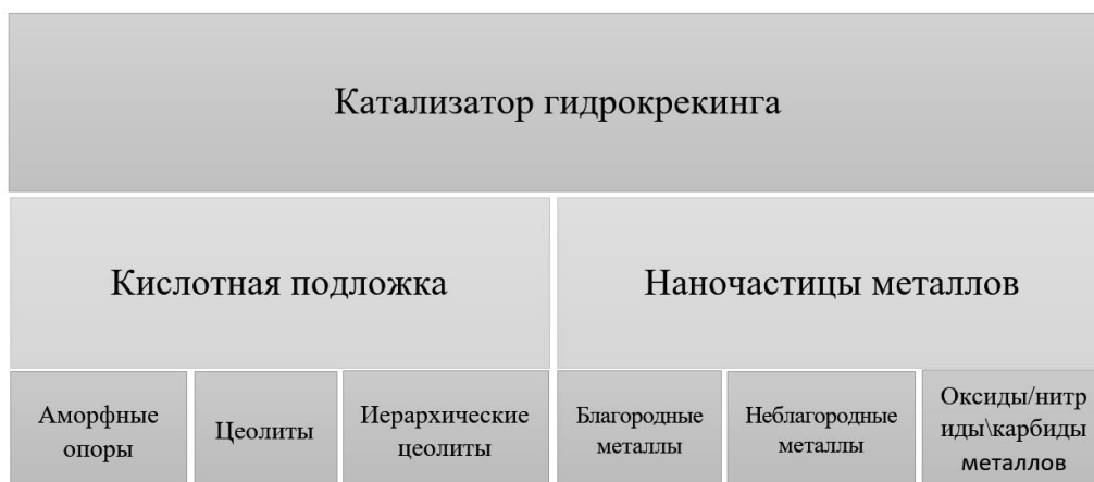
Схема 1. Состав бифункционального катализатора для гидрокрекинга
