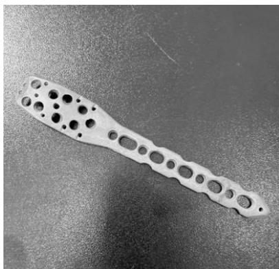
Рисунок 6. Модель пластины для фиксации распечатанный на 3D принтере
