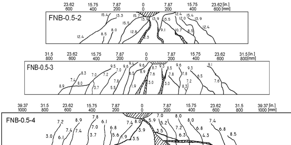
(d) SFRC beams with  $V_f = 0.5\%$
