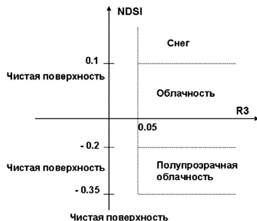
Рис.1. Пороговое разделение пикселей «чистой поверхности», облачности и снежного покрова в двумерном пространстве R3 - NDSI
