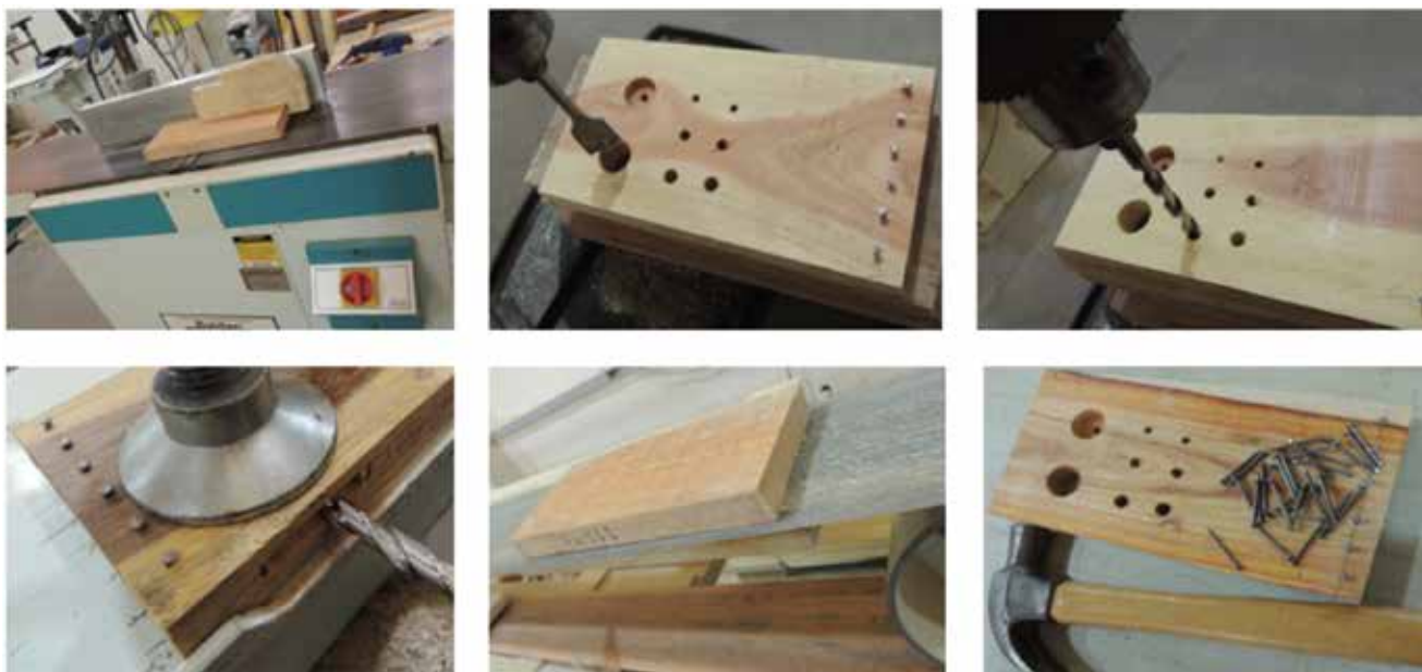
Figura 5. Detalhes da confecção dos corpos-de-prova e dos ensaios de usinagem e trabalhabilidade da madeira.
