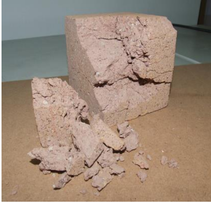
Şekil 3.1.1. Donma-Çözülme Sonrası Numuneden Görünüm
