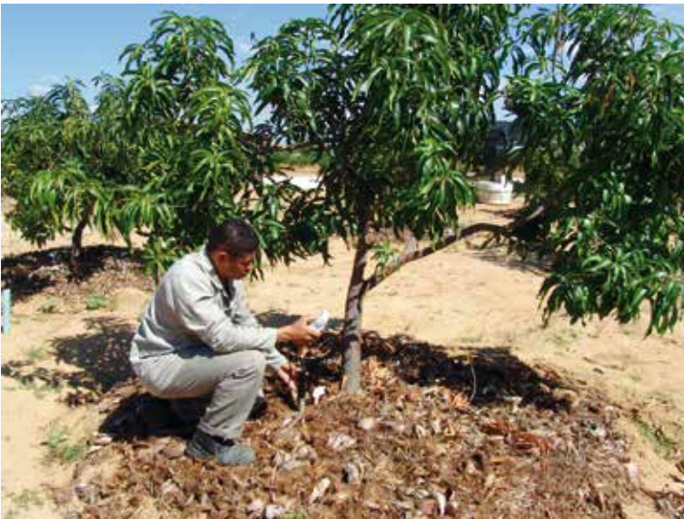
Figura 4. Monitoramento da umidade do solo na área do pomar usando reflectometria no domínio da frequência ( frequency-domain reflectometry – FDR).
