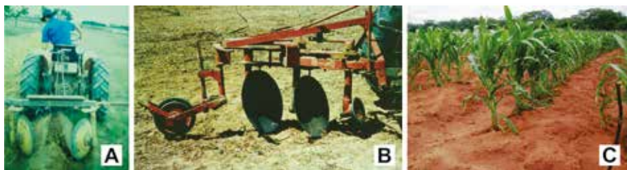
Figura 6. Sulcador de discos adaptado para formação de sulcos e camalhões (A), arado adaptado para efetuar preparo de solo com aração em faixas (B) e sistema de cultivo de milho ( Zea mays ) em camalhões (C).
