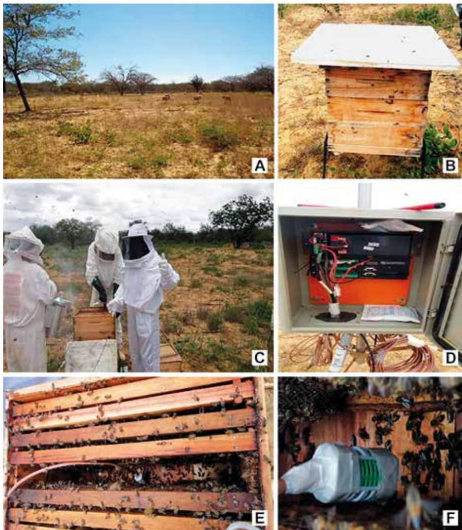
Figura 6. Apiário localizado no Campo Experimental da Caatinga da Embrapa Semiárido (A), colmeia de abelhas melíferas ( Apis mellifera ) com cobertura de placa de gesso (B), instalação dos termopares nas colmeias de abelhas melíferas (C), caixa contendo os registradores de dados (D), termopar instalado próximo aos favos de cria (E) e detalhe do termopar (F).
