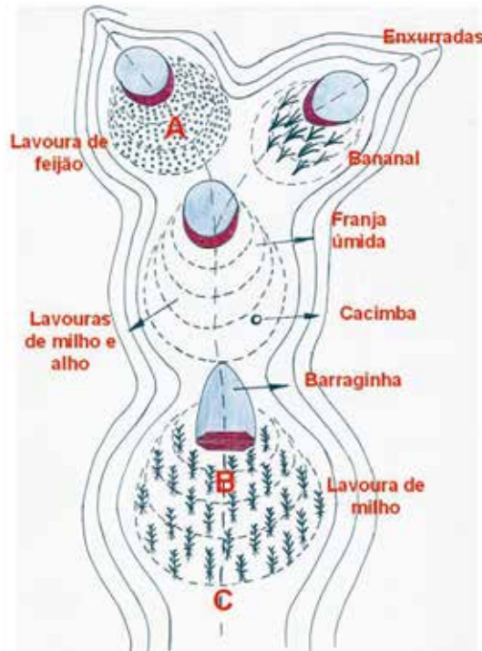
Figura 7. Desenho esquemático de barraginhas implantadas em sequência, proporcionando agricultura pelas franjas úmidas.
