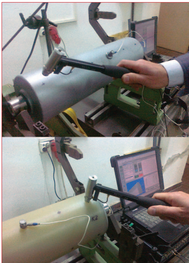
Rys. 2 Dokumentacja fotograficzna z prowadzonych badań wibroakustycznych krążników, po lewej krążnik z płaszczyzną stalową – mocowanie akcelerometru za pomocą podkładki magnetycznej, po prawej krążnik z płaszczyzną poliuretanową – mocowanie akcelerometru za pomocą wosku
