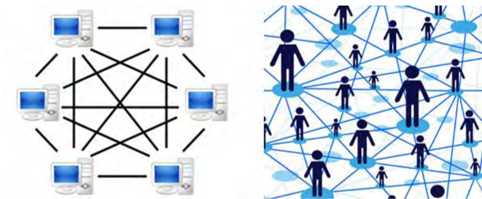
Figura 13 – Comparativo entre a topologia de rede P2P e o conceito da web 2.0.
