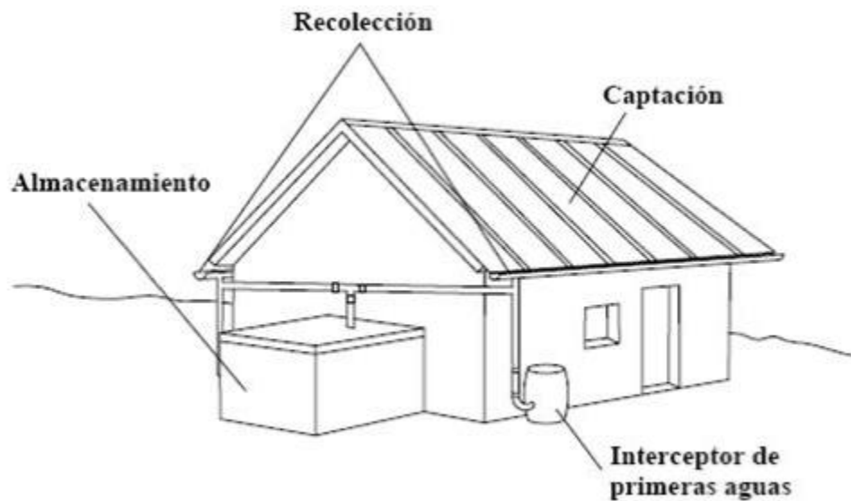
Figura 8. Sistema típico de captación de agua lluvia en techos (CEPIS)
