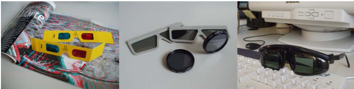
Figura 3.- Ejemplos de sistemas de visión estereoscópica: anaglifos, lentes polarizadas y gafas obturadoras.
