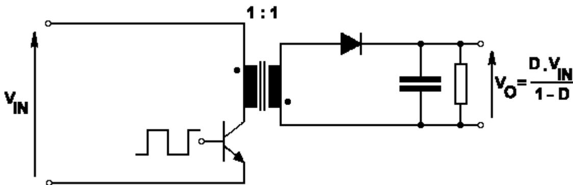
Fig (4.4): Fly Back Converter
