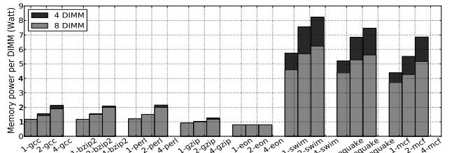
**Figure 5. Memory power per DIMM**
