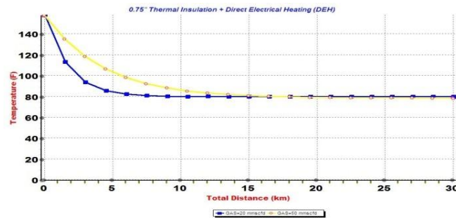
Figure14. 0.75" Thermal Insulation Plus a DEH
