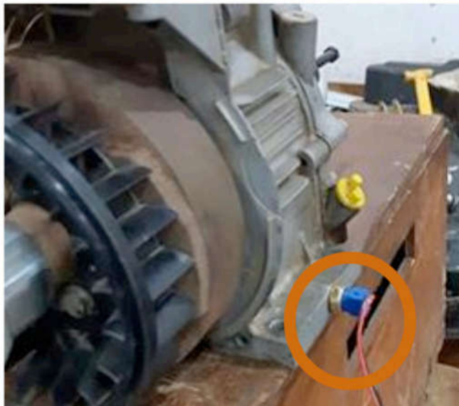
Figura 16 - Sensor capacitivo de nível de combustível XKC Y25 T12V acoplado ao tanque.
