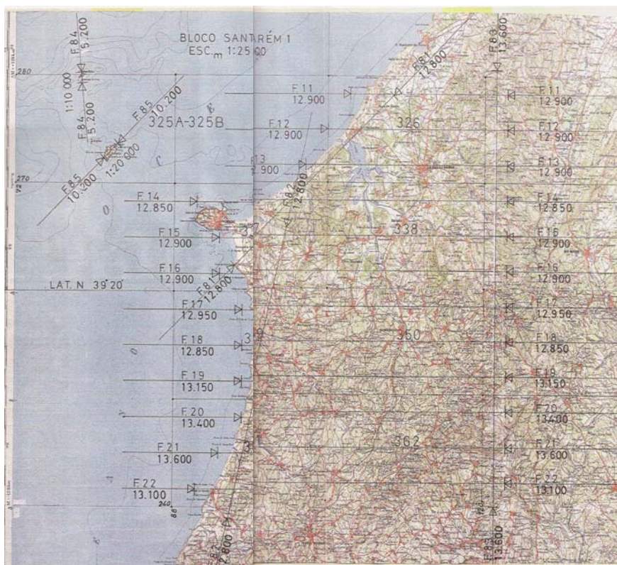
Figura 1.4.2.10. Exemplo de mapa de voo (Cavaca e Sequeira, Relatório de Estágio)
