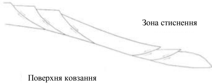
Рисунок 3 – Схема розташування зон розтягування, плоскопаралельного переміщення і стиснення в зсувному масиві [49]
