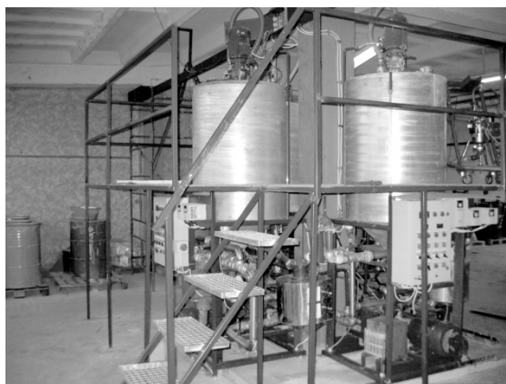
Фото Модуль для подбора рецептур объёмом 50 литров и для приготовления красок серии ПИ-7 в малых количествах
