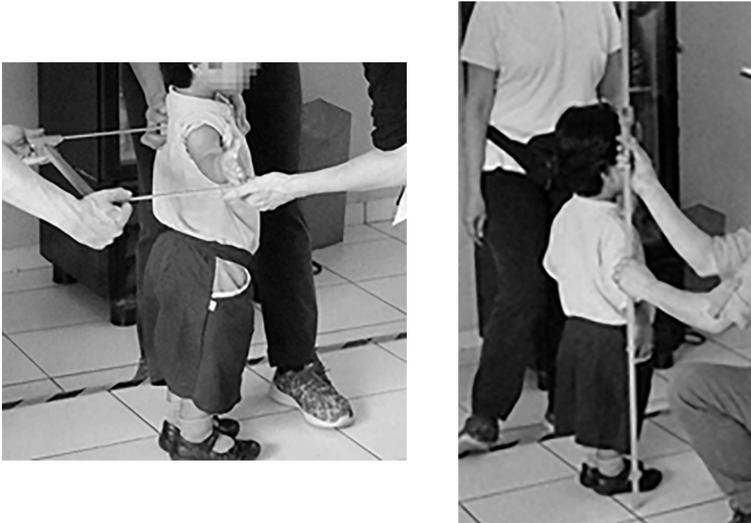
**Figura 3:** Levantamiento medidas antropométricas (Fotos: Laboratorio de Ergonomía – CyAD - UAM-A)
