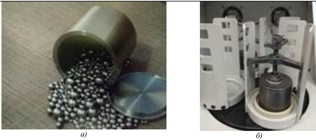
Рисунок 1. Микропорошки соответствующих металлов (а); планетарная шаровая мельница (б).
