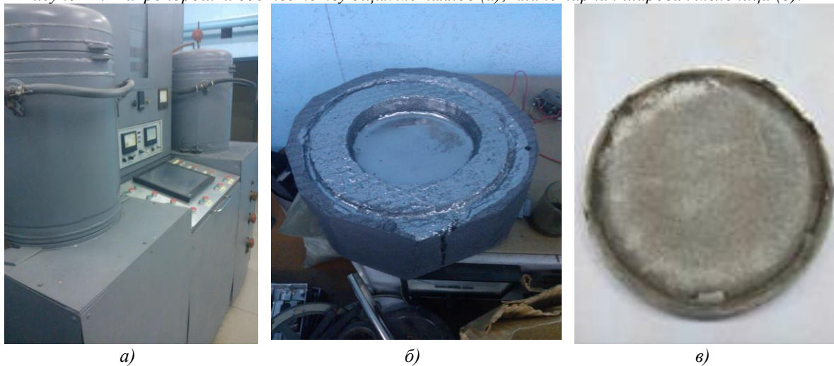
Рисунок 2. Двухколпачковая вакуумная печь (а), графитовая форма для плавки металла (б), вид мишеней CrNiTiZrCu, полученных методом вакуумной плавки (в).
