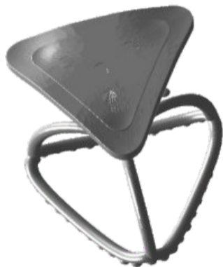
Obr. 20: 3D model taburetu DIPO - OFFICE CRADLE v prostredí DS SolidWorks s aktivovaným nástrojom SustainabilityXpress.
