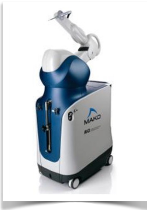
Figura 2. Sistema robótico Mako. Con el uso de Tomografía Computarizada se genera un modelo virtual 3D de la anatomía de cada paciente. Extraído de: www.stryker.com .
