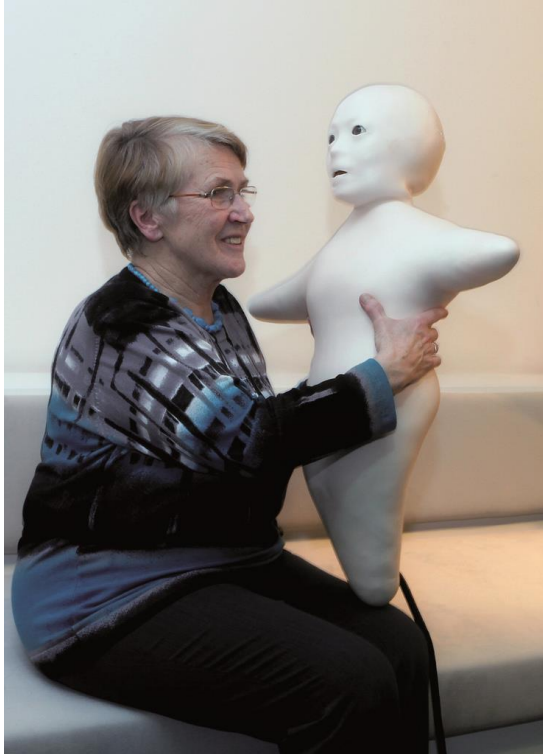
Abbildung 2. Der puppengroße Telenoid überträgt in Echtzeit Stimme, Gestik und Mimik eines Menschen. Sein Entwickler-Team an der Osaka University sieht in ihm eine haptische Alternative zu Handy oder Skype. (Fotocredit: rubra/Ars Electronica)
