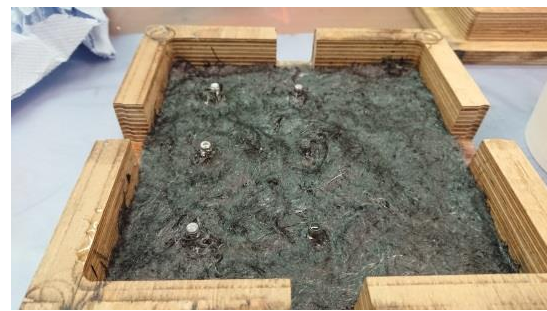
Abbildung 1: Tauchkantenwerkzeug mit eingelegten Faserlagen
