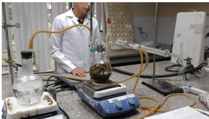
Figura 2. Montaje empleado en la destilación por arrastre de vapor
