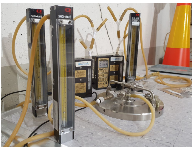
Figur 1. Mätning av emissioner ovanpå ett ytskikt med FLEC. Foto: Polygon | AK.
