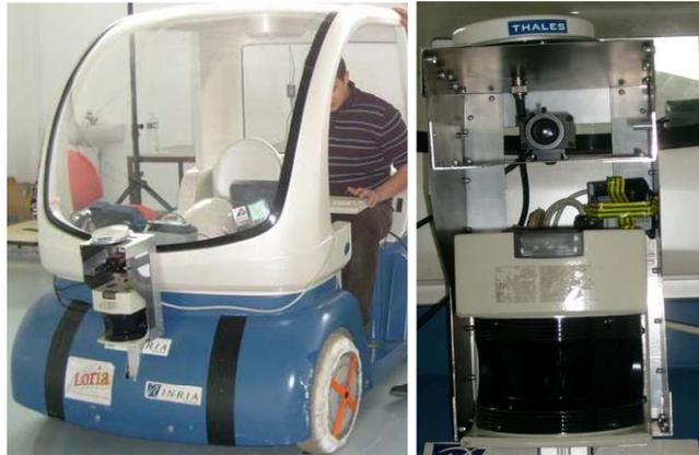
Fig.3: Capteurs embarqués à bord du véhicule
