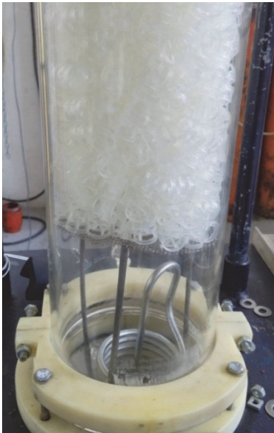
Figura 5. Foto de torre empacada (izquierda) y foto de empaque (derecha).
