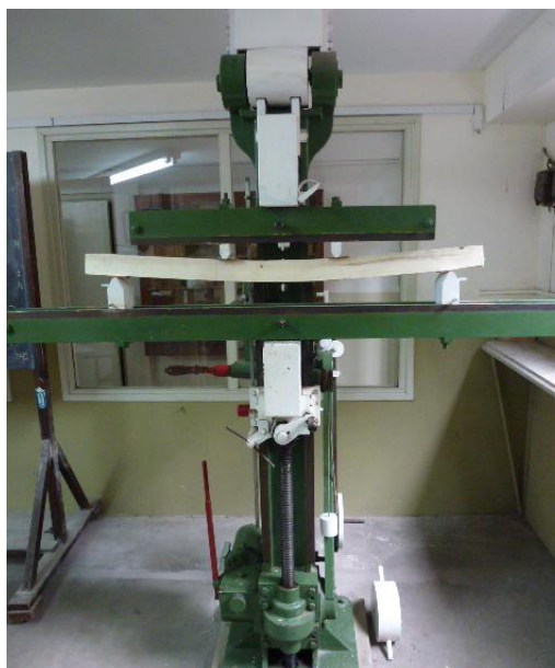
Figura 6: Ensayo en máquina Universal ALFRED J. AMSLER & Co, Schaffouse – Suisse.
