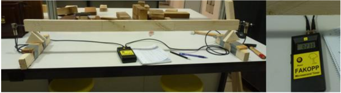
Figura 4. Ensayo en viga bi-apoyada. Ultrasonidos: Microsecond Timer de Fakopp.
