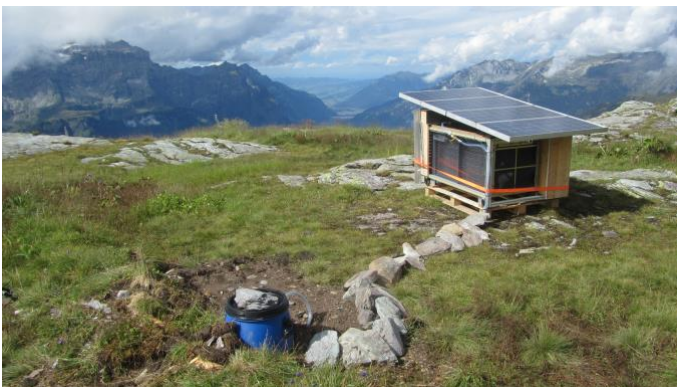
Abbildung 5: UM_Berg: So kann Abwasserbehandlung und Nährstoffrückgewinnung auf 2200 Meter Höhe aussehen: Ein Pilotprojekt zur Urinverdunstung an einer Schweizer Berghütte
