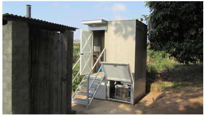
Abbildung 6 & 7: Durban_1 oder Durban_2: Alt und Neu - Zwei Toilettengenerationen bei einem Feldversuch der komplett autarken Blue Diversion Autarky Toilette in Südafrika
