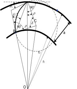
**Fig. 7.** Curvature of the blades <sup>[11]</sup>
