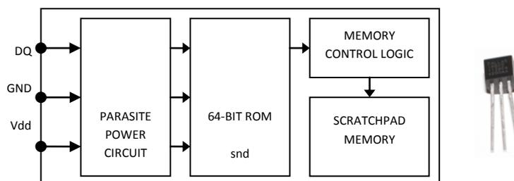
Fig. 1 Simplified block diagram of DS18B20 temperature sensor
