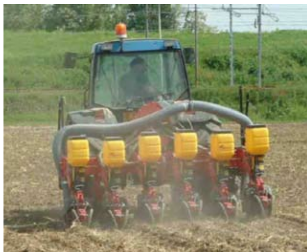
Figura 4 - Seminatrice pneumatica equipaggiata con il "dual pipe deflector" nel corso di una prova di semina. E' visibile l'effetto deriva dovuto al vento trasversale rispetto alla direzione di semina.
