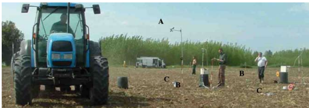
Figura 6 - Passaggio del sistema trattore-seminatrice di fronte alla postazione di rilievo a metà parcella. Sono visibili: A, anemometro per il rilievo continuo di direzione e velocità del vento; B, Campionatori d'aria a 5 e 10 m dal bordo della parcella, a terra e a 170 cm di altezza; C, alcune piastre Petri al suolo con accanto le gabbiette contenenti gruppi di 30-35 api esposte direttamente alle polveri.
