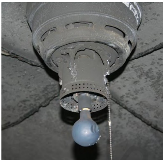
Obrázok 8-13 Smer preliačenia žiarovky (s príkonom do 25 W) indikuje smer dopadajúceho tepelného toku (NFPA 921:2014)
