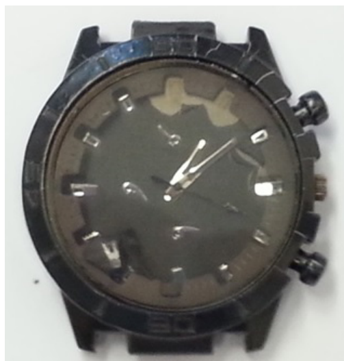
Obrázok 8-1 Hodiny po termickom zatažení na teplotu 330 °C s rýchlosťou ohrevu 1 °C.min -1
