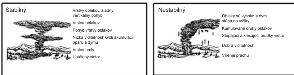
Obrázok 7-16 Pohyb dymu v ovzduší pri stabilných (vľavo) a nestabilných (vpravo) podmienkach (Drysdale 1999)
