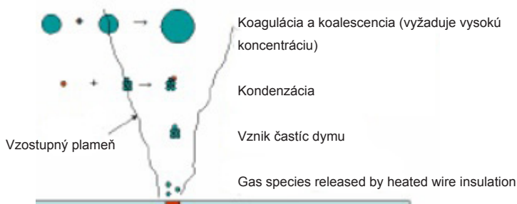
Obrázok 7-3 Proces koagulácie častíc dymu (Drysdale 1999)
