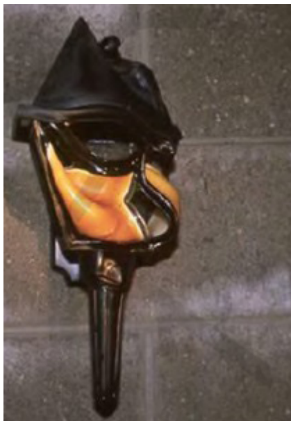
Obrázok 8-11 Roztavené svetidlo indikuje smer šírenia tepla (NFPA 921:2014)
