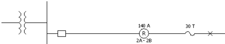
FIGURA 11.22 Coordinación restaurador-fusible en un ejemplo práctico.
