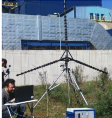
Figura 2: Fotografía del arreglo de micrófonos utilizado.
