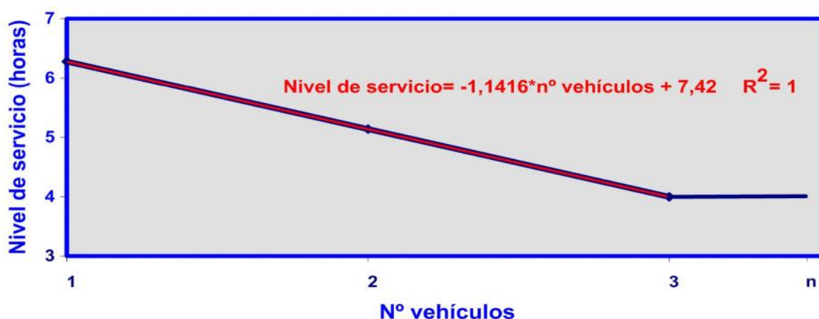
Gráfico 10: Relación entre el número de vehículos y el nivel de servicio para el caso B
